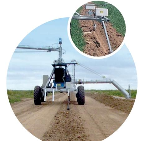
Выравнивание кабелем двойного действия оптимизирует перпендикулярность пролётов с ведущей тележкой
