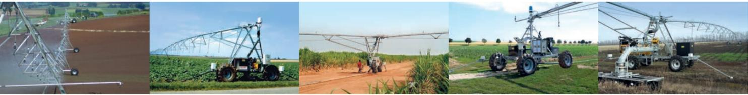
Наши фронтальные установки: длиной до 1 400 м с забором воды на канале, длиной до 600 м с забором воды при помощи шланга или из РЕ (полиэтилен) на участках с уклоном (<10% скос). Расход воды до 720м<sup>3</sup>/ч.
