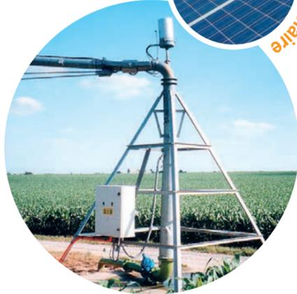
Fixe ou mobile, le centre pivot est arrimé à une dalle en béton
