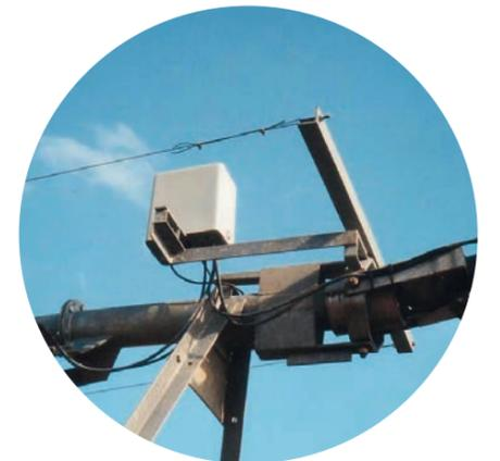
L'alignement, par câble double-action, optimise la perpendicularité des travées avec la motrice.
